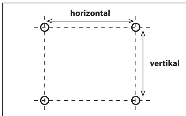
Um die Lochabstände des Monitors zu ermitteln, müssen die horizontalen und vertikalen Abstände der Gewindelöcher auf der Monitorrückseite gemessen werden.
